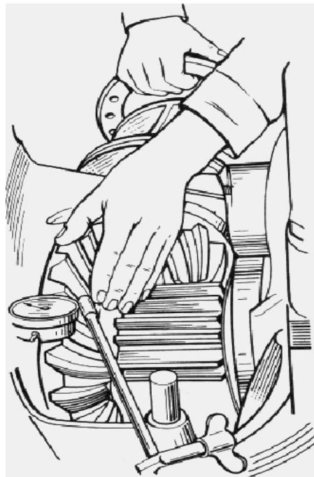
Рис. 37. Проверка бокового зазора в зацеплении конических шестерен
