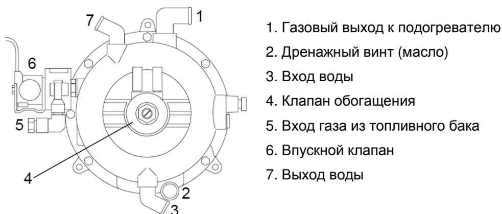
**Рис. 604 Проверка газового редуктора для пропана (LGW 300)**
