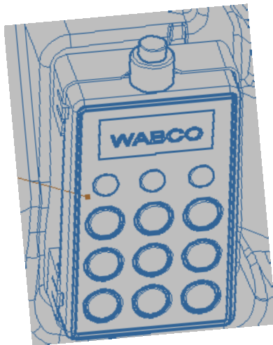
S22 - Дистанционный пульт управления пневмоподвеской 446 056 137 0
